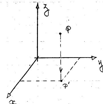
$$\begin{bmatrix} x' \\ y' \\ z' \\ w' \end{bmatrix} = \begin{bmatrix} 1 & 0 & 0 & 0 \\ 0 & 1 & 0 & 0 \\ 0 & 0 & 0 & 0 \\ 0 & 0 & 0 & 1 \end{bmatrix} \begin{bmatrix} x \\ y \\ z \\ w \end{bmatrix}$$
