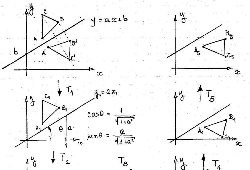
$$M = \begin{bmatrix} 1 & 0 & 0 \\ 0 & 1 & b \\ 0 & 0 & 1 \end{bmatrix} \left( \frac{1}{\sqrt{1+a^2}} \begin{bmatrix} 1 & -a & 0 \\ a & 1 & 0 \\ 0 & 0 & 1 \end{bmatrix} \right) \begin{bmatrix} 1 & 0 & 0 \\ 0 & -1 & 0 \\ 0 & 0 & 1 \end{bmatrix} \left( \frac{1}{\sqrt{1+a^2}} \begin{bmatrix} 1 & a & 0 \\ -a & 1 & 0 \\ 0 & 0 & 1 \end{bmatrix} \right) \begin{bmatrix} 1 & 0 & 0 \\ 0 & 1 & -b \\ 0 & 0 & 1 \end{bmatrix}$$
