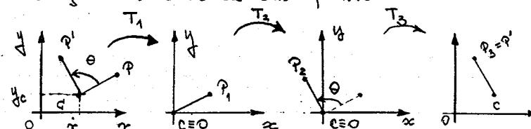
$$M_1 = \begin{bmatrix} 1 & 0 & -x_c \\ 0 & 1 & -y_c \\ 0 & 0 & 1 \end{bmatrix} \quad M_2 = \begin{bmatrix} \cos \theta & -\sin \theta & 0 \\ \sin \theta & \cos \theta & 0 \\ 0 & 0 & 1 \end{bmatrix} \quad M_3 = \begin{bmatrix} 1 & 0 & x_c \\ 0 & 1 & y_c \\ 0 & 0 & 1 \end{bmatrix}$$
