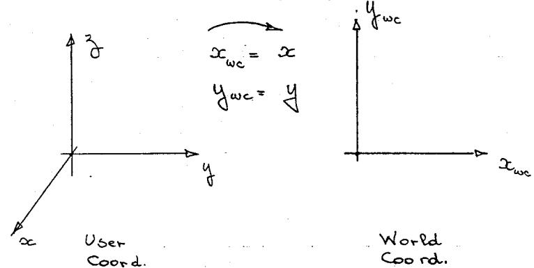
$$\begin{bmatrix} x_{wc} \\ y_{wc} \\ z_{wc} \end{bmatrix} = \begin{bmatrix} 1 & 0 & 0 \\ 0 & 1 & 0 \\ m_{31} & m_{32} & m_{33} \end{bmatrix} \begin{bmatrix} x \\ y \\ z \end{bmatrix}$$
