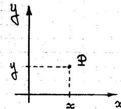
$$\begin{pmatrix} x \\ y \\ 1 \end{pmatrix} \triangleq \begin{bmatrix} x \\ y \\ 1 \end{bmatrix} \triangleq \begin{bmatrix} w \\ x \\ y \\ w \end{bmatrix} = \begin{bmatrix} x_w \\ y_w \\ w \\ w \end{bmatrix} \quad w \neq 0$$
