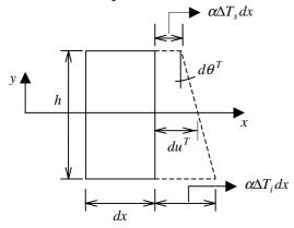
Deslocamento axial relativo interno provocado pela variação de temperatura:
