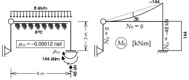
Diagrama de momentos fletores do caso (0) só depende da força uniformemente distribuída aplicada na viga, pois variação de temperatura e recalque de apoio não provocam esforços internos no SP isostático.
