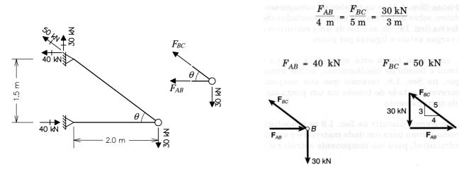
$$\sum F_y = 0 \Rightarrow F_{BC} \cdot \sin \theta - 30 \text{ kN} = 0 \Rightarrow F_{BC} \cdot 3/5 = 30 \text{ kN} \quad \therefore F_{BC} = +50 \text{ kN (com o sentido arbitrado)}$$
