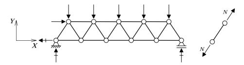
Um procedimento que pode ser adotado para determinar os esforços normais em uma treliça plana (isostática) é o chamado *método do equilíbrio nodal*:
