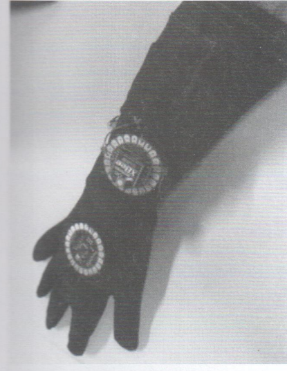
Figura 13: v-Glove, um dispositivo de interação 3D baseado em uma interface de toque.
