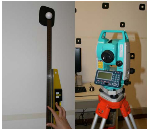
Figura 4: Modo de medição simples dos marcadores simples, à esquerda e a estação total à direita.
