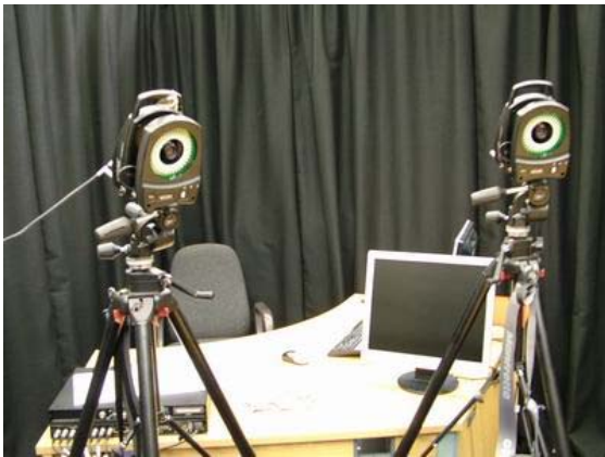
Figura 2: Sistema óptico da VICON para geração de dados de referência. Fonte: VICON
