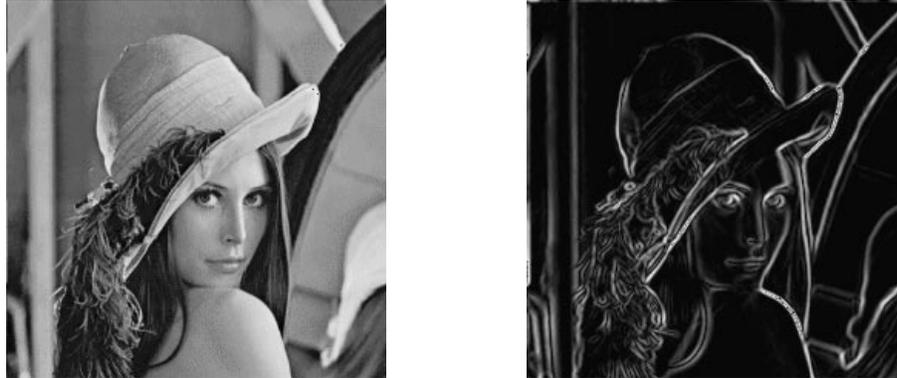
Figura 4.3: Exemplo de segmentação por frequência utilizando transformada wavelet. Figura extraída de (Gomes *et al.*, 1997b).
